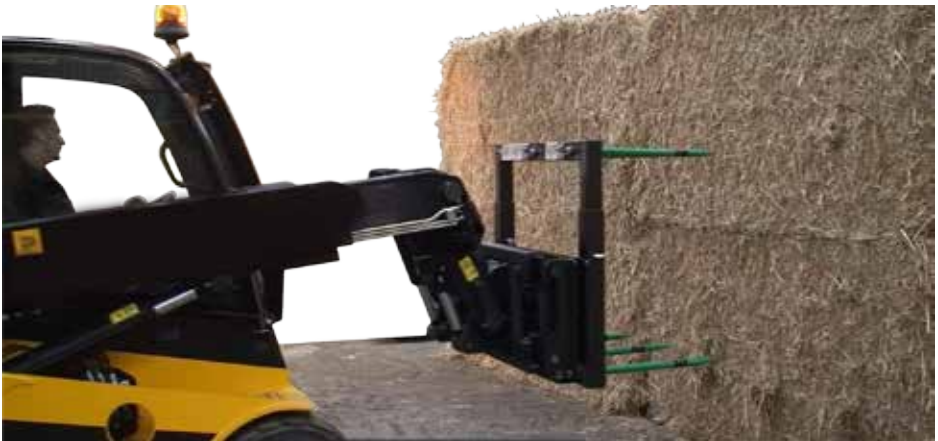
Grúa cargadora telescópica con 6 púas y sistema de pesaje. El iPad se ubica en la cabina. Transferencia Bluetooth entre las sondas y el sistema de pesaje al iPad. No se requieren cables.
